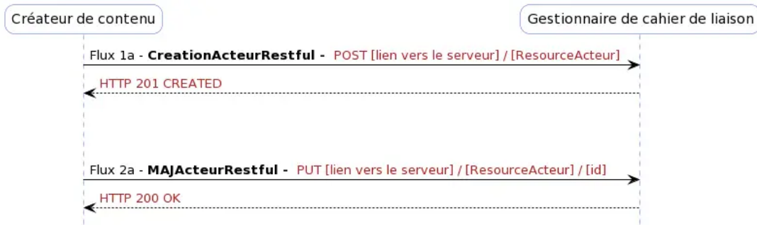
Figure 1 - Diagramme de séquence des flux 1a et 2a
