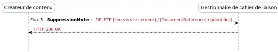
Figure 3 - Diagramme de séquence du flux 3c
