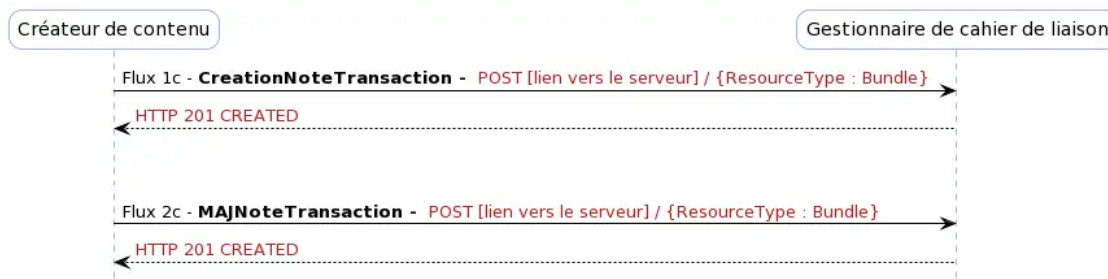
Figure 5 - Diagramme de séquence des flux 1c et 2c
